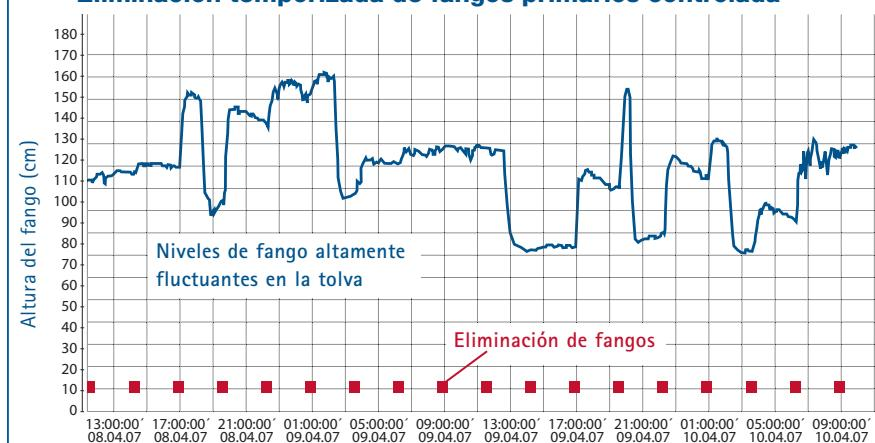
Fig. 2: Eliminación temporizada de fangos primarios. Cuando el nivel en las tolvas para lodos es bajo, un innecesario gran volumen de agua entra en el digestor.
